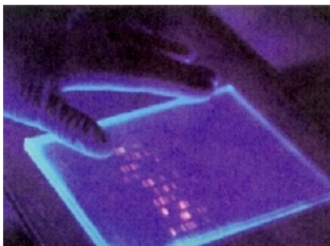
Foto de um gel de eletroforese iluminado com luz ultravioleta. Sob essa luz, o DNA previamente tratado fluoresce, revelando um padrão de faixas típico de DNA analisado.
